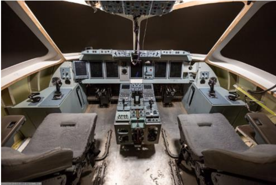
Рис. 16: Макет кабины экипажа SSI-100 на стенде “Электронная птица”
